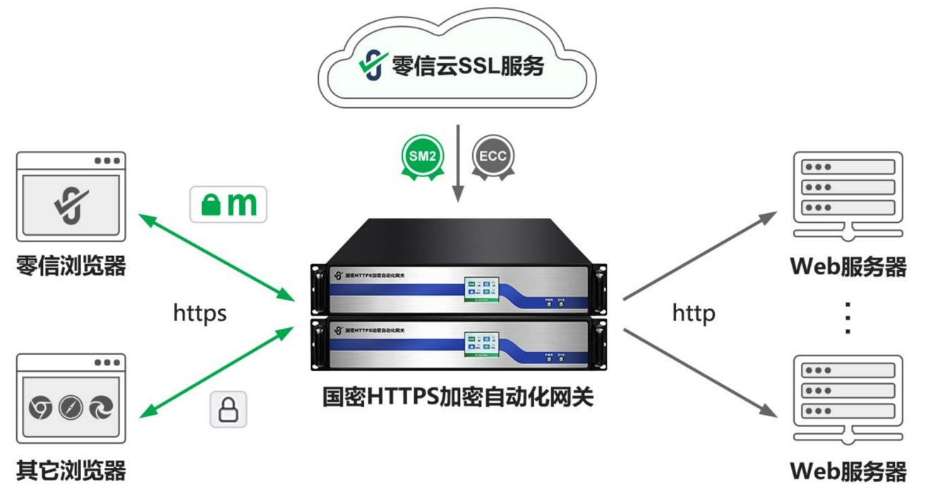
加密所需的双算法双SSL证书由HTTPS加密自动化网关自动对接零信云SSL系统自动化完成双SSL证书的申请、域名验证、获取证书、安装证书和启用证书。自动配置的ECC SSL证书全球信任，支持国际证书透明安全，由零信自有品牌中级根证书ZoTrus ECC DV SSL CA签发，顶级根证书是全球最老的ECC算法根证书Sectigo ECC，全链采用ECC算法，加密速度比RSA算法快18倍，让用户访问网站更快。自动配置的国密SM2 OV SSL证书国密合规，支持所有国密浏览器，是支持国密证书透明安全的国密SSL证书，由零信自有品牌中级根证书SM2 SSL Pro CA签发，顶级根证书是拥有国密局和工信部CA许可证的贵州CA国密根证书Guizhou SM2 CA，全链采用SM2算法，加密速度比RSA算法快20倍，让用户访问网站更快。
