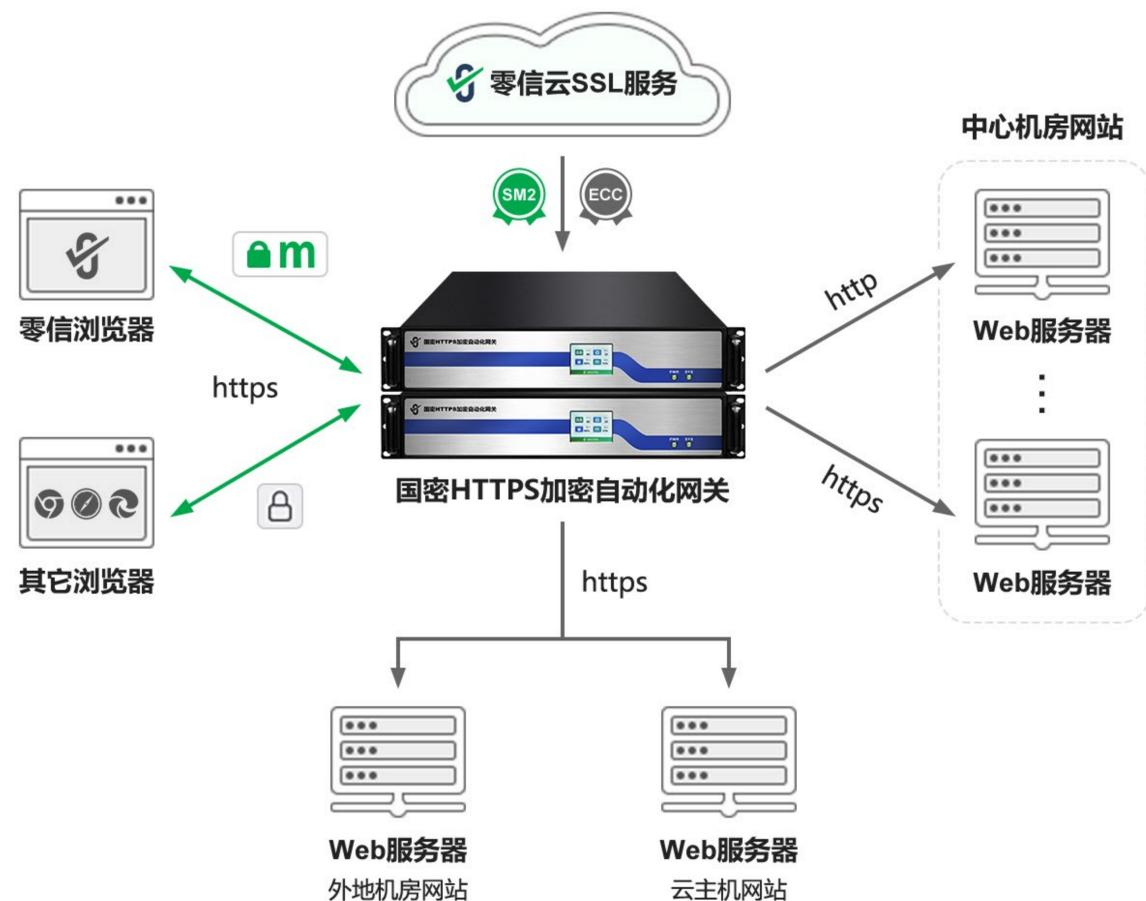
对于不仅有本地服务器需要实现HTTPS加密自动化服务，而且还有外地分支机构的Web服务器或有部署在云上的多个网站也需要HTTPS加密自动化服务的用户，零信网关同时支持本地转发模式和远程回源模式。无论Web服务器(网站)是在外地机房还是云主机，只要网关能通过公网或者内网能访问，则这些网站就是类似于CDN服务的回源源站，都可以由网关来为它们提供HTTPS加密自动化服务和WAF防护服务。双网关最多为255个网站提供HTTPS加密自动化服务和WAF防护服务，更多网站需要购置更多台网关。
