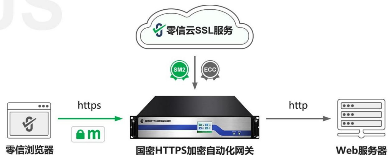
零信国密HTTPS加密自动化网关最大的特点和特色是零申请SSL证书、零安装SSL证书、自动化实现国密HTTPS加密，自适应加密算法，支持国密算法和国密证书透明的浏览器采用SM2算法实现国密https加密，不支持国密算法和国密证书透明的浏览器采用ECC算法实现https加密。这是一个端云一体的创新解决方案，国密HTTPS加密自动化网关内置国密ACME客户端，自动对接零信云SSL系统完成自动化双SSL证书申请、部署和续期，确保业务系统零改造实现https加密，不间断地自动化为多达255个不同域名的业务系统提供自动化https加密服务和WAF防护服务。
